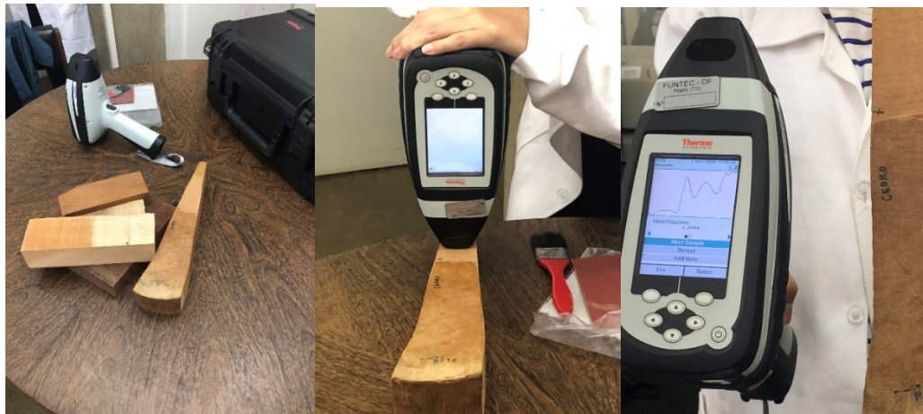
Figura 1. Aparato de espectroscopia de infrarrojo cercano (NIRS) que se está probando en la identificación de la madera.
